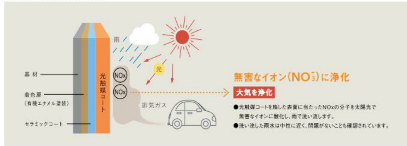
■ 光触媒コートによる大気浄化のしくみ
